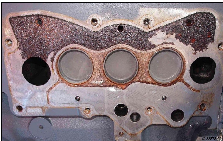
A7: Skrzynia korbowa w obszarze obudowy chłodnicy oleju smarowego
