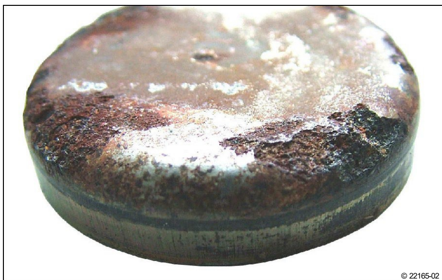
A11: Pokrywa uszczelniająca, skorodowana
