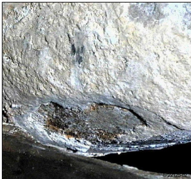
A13: Osady kamienia na tulei cylindrowej
