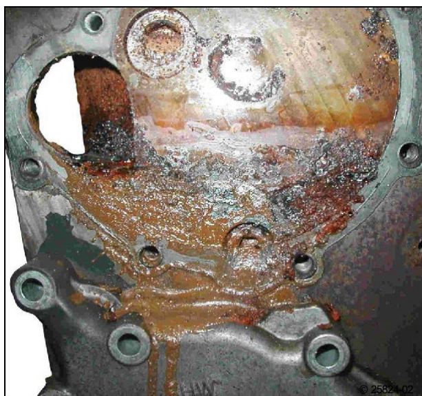
A9: Gniazdo pompy płynu chłodzącego na skrzyni korbowej
