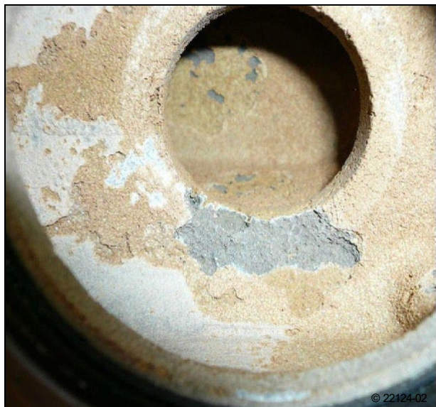
A12: Aluminiowa pokrywa termostatu, skorodowana
